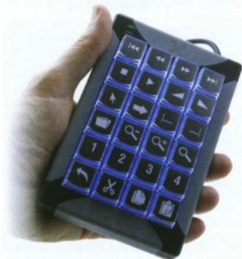
Das XK-24 Keypad sorgt für einen perfekten Mix aus individuellem Layout, eigener Tastenprogrammierung, LED und USB
