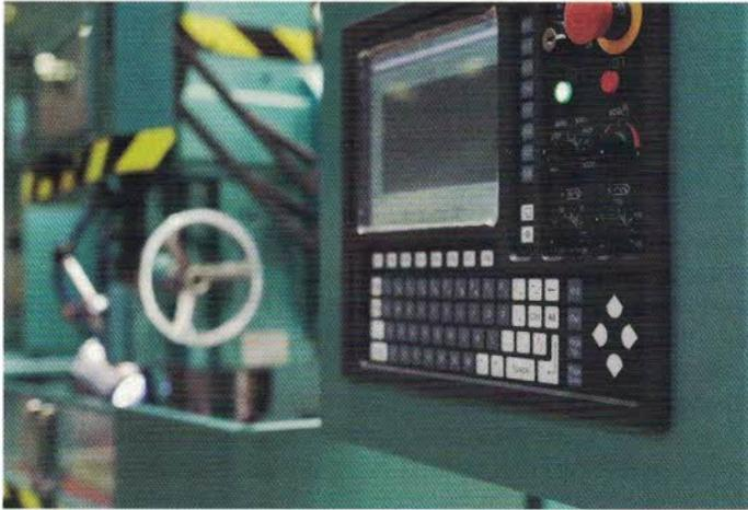
**Bild 1: Bedienfeld einer CNC-Metallbearbeitungsmaschine mit integrierter Industrietastatur © GeBE/iStock**
