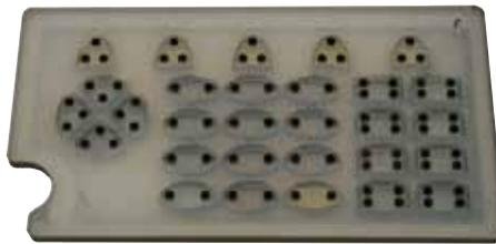
**Die Anordnung der Pillen:** Sie lassen das Licht sehr gut und ohne störende Schatten an der Oberfläche der Taste erscheinen
