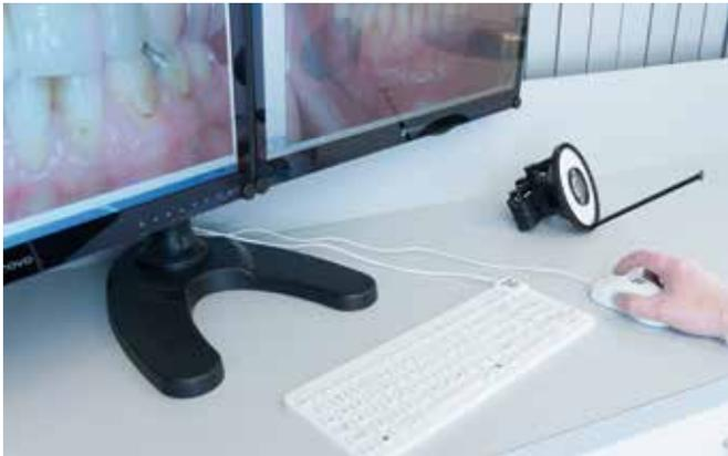
Die Really-Cool Tastaturen sind wasserdichte Premium-Tastaturen: Mit einer besonderen Silikonveriegelung versehen, sind sie komplett desinfizierbar und haben einen exzellenten Tastenanschlag.
