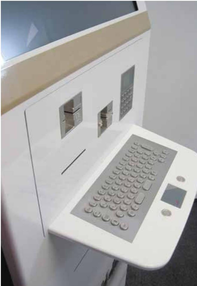
Die Edelstahlfrontplatten als Einbauversion sind mit 62 bis 86 Tasten ausgestattet. Die Tastaturen stehen für einen hohen Bedienkomfort durch die Langhubtasten mit 3,25 mm Betätigungshub und die taktile Rückmeldung. Ideale Einsatzbereiche sind Automaten, Info-Terminals, Zugangskontrollen sowie anspruchsvolle Industrieumgebungen.
